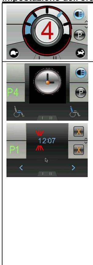
Selezionare la funzione di programma mediante il pulsante di selezione del campo (9) e sul display appare il menu per le funzioni speciali.
