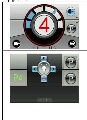
Selezionare la funzione d'illuminazione mediante il pulsante di selezione del campo (9) e sul display appare il menu per la selezione dell'illuminazione.
