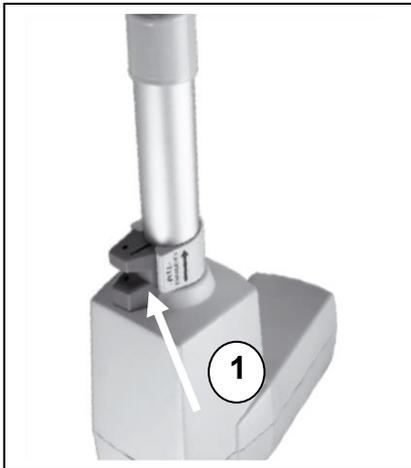
In caso di assenza di alimentazione o di batterie scariche, l'abbassamento di emergenza può essere effettuato premendo il pulsante rosso ① posto all'estremità inferiore del motore. L'abbassamento di emergenza predefinito è impostato per un paziente del peso di 75 Kg.
