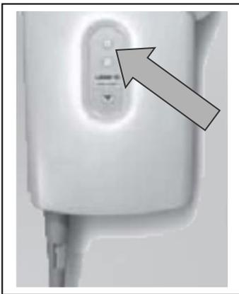
Quando le batterie sono sotto carica si accende una luce gialla sul LED superiore.
