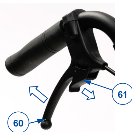
Figura 7 Azionamento dei freni a tamburo
