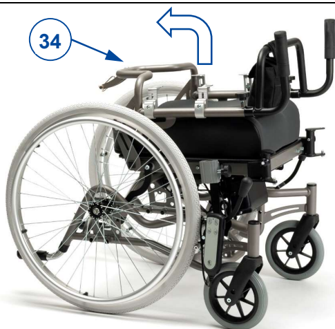
Obrázek 3 Základní rám invalidního vozíku Inovys II-E s koly velikosti 16" a 24" – demontované části
