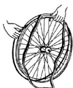
Collocare la protezione della camera d'aria sulla valvola di gonfiaggio prima di inserirla nel cerchio. A questo punto è possibile tirare facilmente la protezione oltre il bordo. Verificare che tutte le teste dei raggi siano coperte (la protezione della valvola non è necessaria per i cerchi in plastica).
