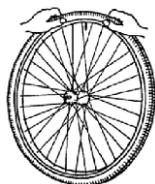
Se la camera d'aria si inserisce nel copertone senza pieghe (in presenza di pieghe fare fuoriuscire una parte dell'aria), è possibile premere leggermente con entrambe le mani il lato superiore del copertone sul cerchio, iniziando in corrispondenza della valvola di gonfiaggio. Spingere delicatamente verso l'interno la valvola di gonfiaggio, quindi estrarla nuovamente per accertarsi che lo pneumatico sia posizionato correttamente nell'area della valvola stessa.
